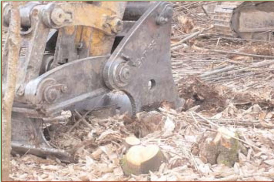
Extirpation au croque souches - CRPF Limousin
