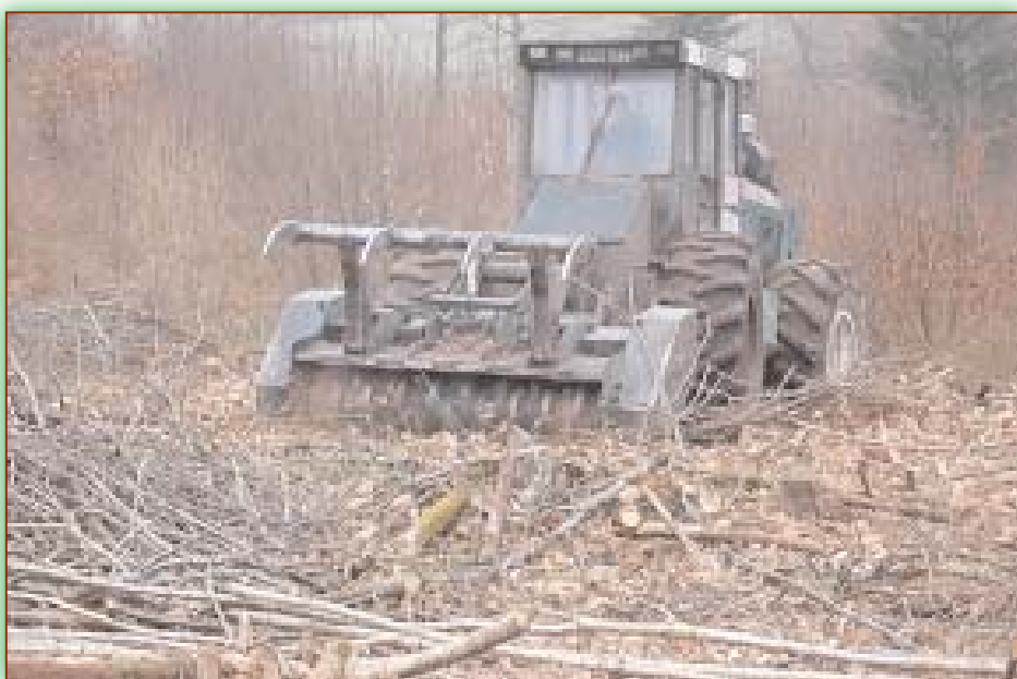
Broyage de souches et de rémanents de châtaignier - CRPF Limousin
