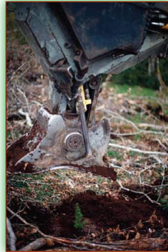
Pages précédentes et ci-dessus : exemples de mise en place de plants en godet (manuelle et mécanisée) - © CFBL
